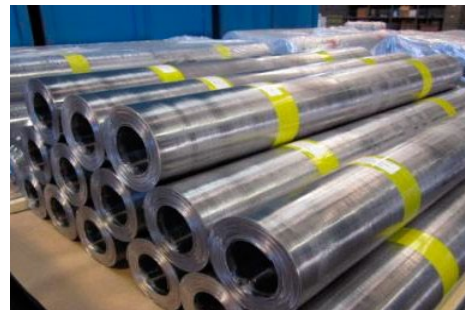
La plancha de plomo de 5x1 m. se entrega sobre palet y enrollada como una alfombra.
